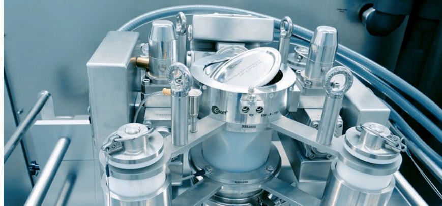
Für die Produktzuführung kommt eine Glatt-Containmentklappe aktiv/passiv vom Typ TKS zum Einsatz. Hier die Aktivklappe in der Trichteröffnung.
