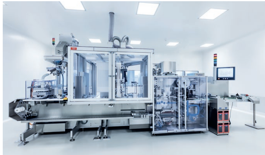
Verpackt wird der innovative Desiccant-Blister auf einer entsprechend modifizierten Uhlmann-Blistermaschine B 1240.
