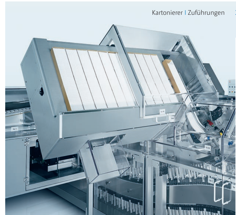
Speichersystem zur Aufnahme mehrlagig geklebter oder gewickelter Broschüren
