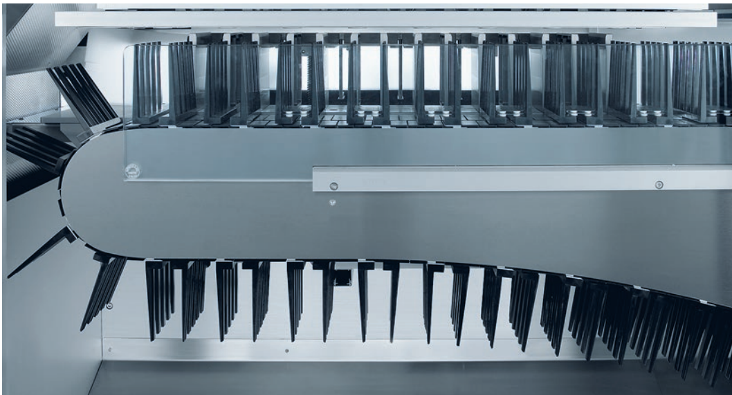
Zuführsystem für Blister: vielfach bewährt, vielseitig einsetzbar für unterschiedlichste Blisterformate
